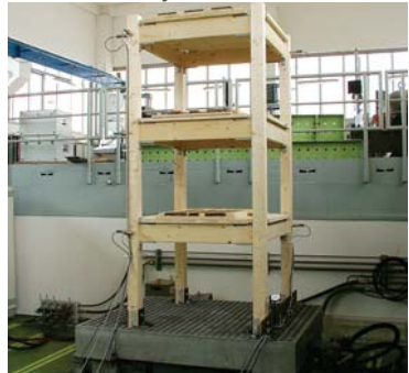
Dynamická analýza rámové konstrukce na vibračním stole
