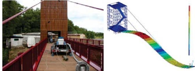
Experimentální modální analýza lávky pro pěši a její numerický model
