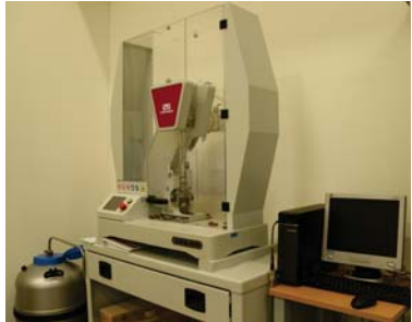
Instrumentované Charpyho kladivo Instron - CEAST
