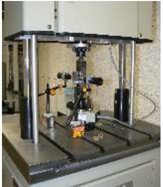
Cyklování CT vzorku a určení kinetiky růstu trhliny
