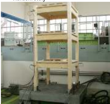
Dynamická analýza rámové konstrukce na vibračním stole
