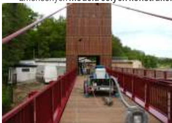
Experimentální modální analýza lávky pro pěší a její numerický model
