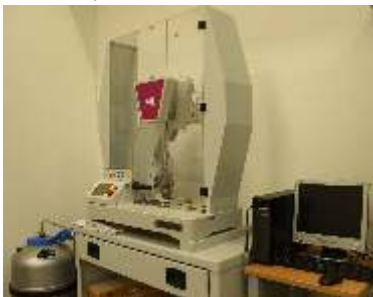
Instrumentované Charpyho kladivo Instron - CEAST
